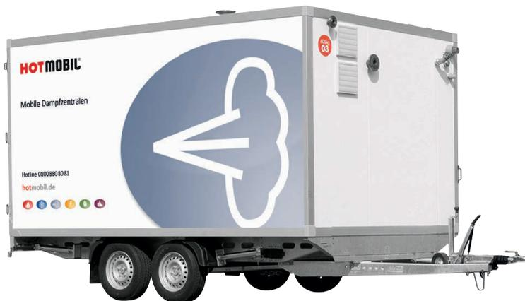
Die mobile Dampfzentrale MDZ 600 ist eine fahrbare und sofort betriebsbereite Dampfanlage auf einem Tandemanhänger für den mobilen Einsatz und autarken Betrieb. Die Anlage ist ausgestattet mit Wasserservicemodul, Wasseraufbereitung, Härteüberwachung, Automatikstarteinrichtung für autom. Betrieb und Außerbetriebnahme, Wasserprobekühleinrichtung und automatischer Chemikaliendosierung.
